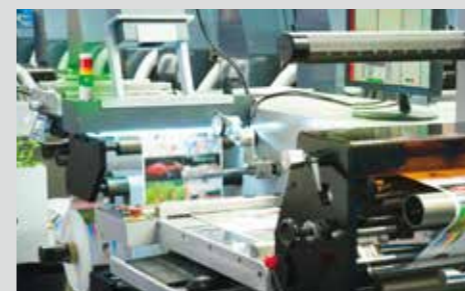
인쇄기나 검사기 등의 PC 제어 장치의 상태 표시
